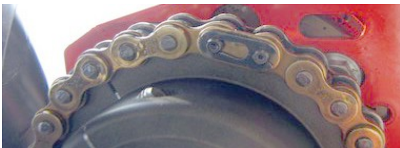
Figura 5 La falsa maglia che collega i due capi della catena. Smontando la mollettina nera si sfilano i perni e si libera la catena. L'apertura della mollettina va posizionata dalla parte opposta al senso di trascinamento
