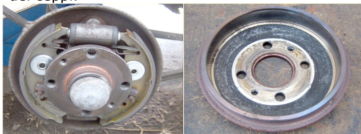
Figura 12 Freno a tamburo: complessivo pistoncino e ceppi. Tamburo smontato
