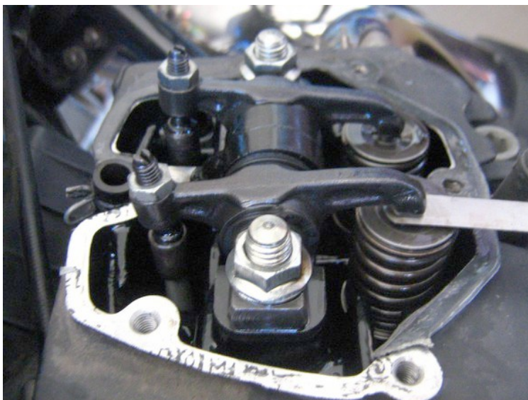
Figura 6 Controllo del gioco valvole tramite spessimetro in un motore ad aste e bilancieri. A sinistra la vite filettata di regolazione e il dado di bloccaggio
