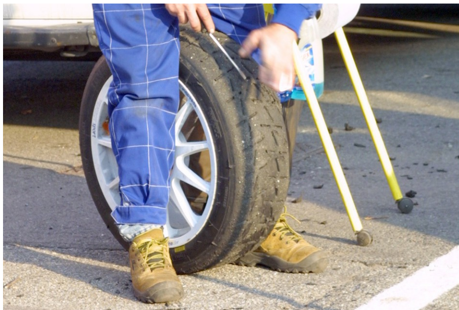
Figura 15 Intaglio della gomma per adattarne le caratteristiche
