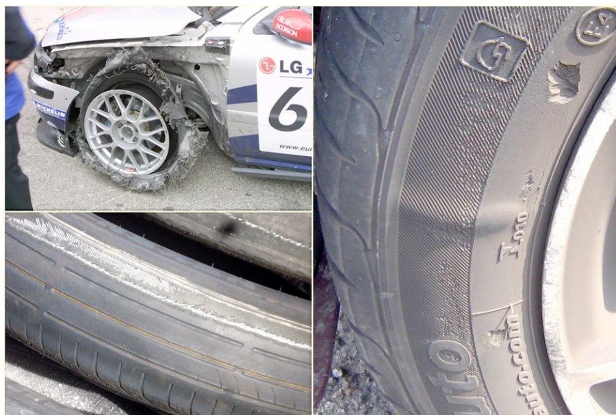
Figura 14 Gli effetti devastanti dello scoppio del pneumatico. Sotto, un'usura eccessiva e irregolare e la tipica "bozza" da marciapiede
