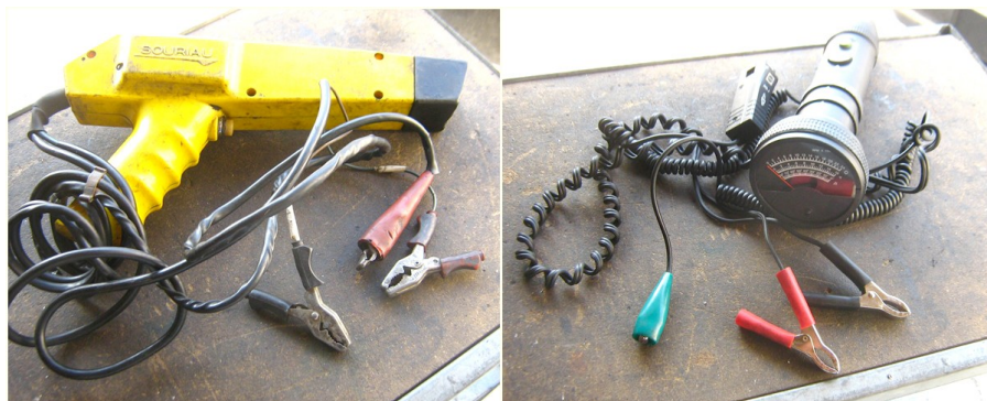
Figura 9 Vecchio tipo, si notano le due pinze per i poli batteria e la pinza da collegare alla candela per leggere il momento di accensione. Più recente, con anche la pinza per il positivo bobina che permette di leggere i giri/minuto. Questo tipo di lampada legge anche il tempo di ricarica della bobina (angolo di Dowell)
