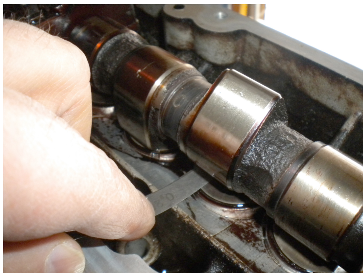
Figura 7 Controllo del gioco valvole albero a camme in testa. Per la registrazione si sostituisce la pastiglia calibrata
